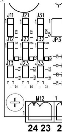
Configurazione ponticelli per sonde NTC (Default):
