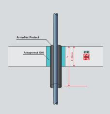
Montage bei Kunststoffrohren.
