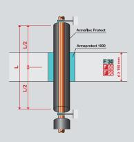
Armaflex Protect kann auch in Deckendurchbrüchen zentriert montiert werden. Der verbleibende Spalt in der Durchführung oder der Kernbohrung wird mit Armaprotect 1000 oder nichtbrennbaren, formbeständigen Baustoffen wie z. B. Beton, Zementmörtel etc. verschlossen.
