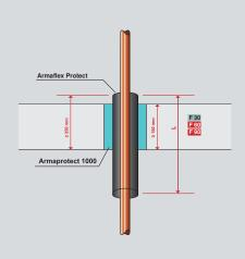
Wenn keine Isolierung über der Decke erforderlich oder möglich ist, kann Armaflex Protect auch unter der Decke installiert werden. Auf diesen Weg können beispielsweise Heizkörperanbindungen einfach und sicher verschlossen werden.
