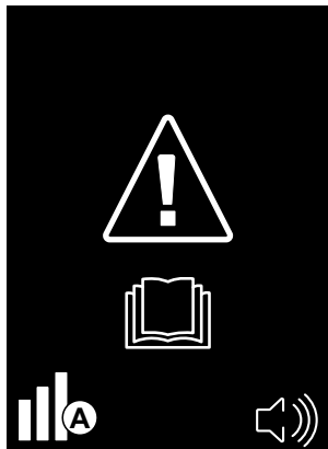
Fig. 17: Indicazione di difetto di un componente
